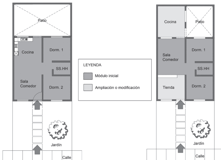
Figura 3. Ampliación de un módulo de vivienda, barrio TP, Piura
